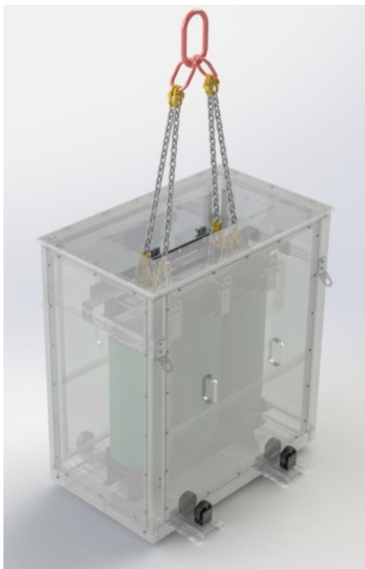
Figura 4 - Demonstração de içamentos de transformador
