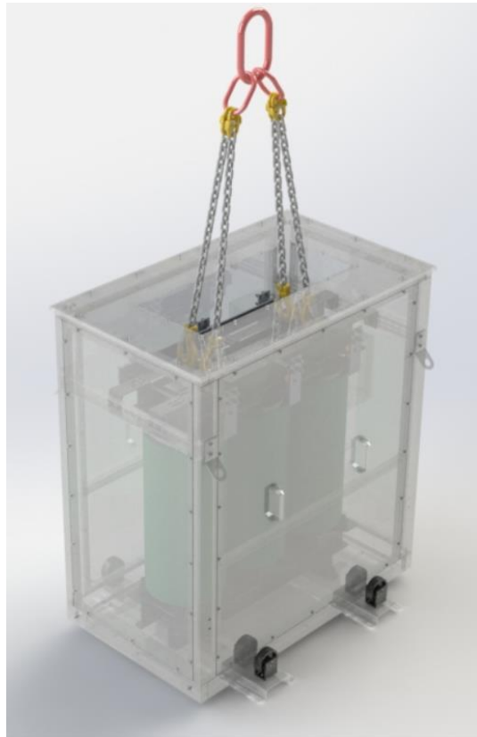
Figura 1: Demonstração de içamentos de transformador
