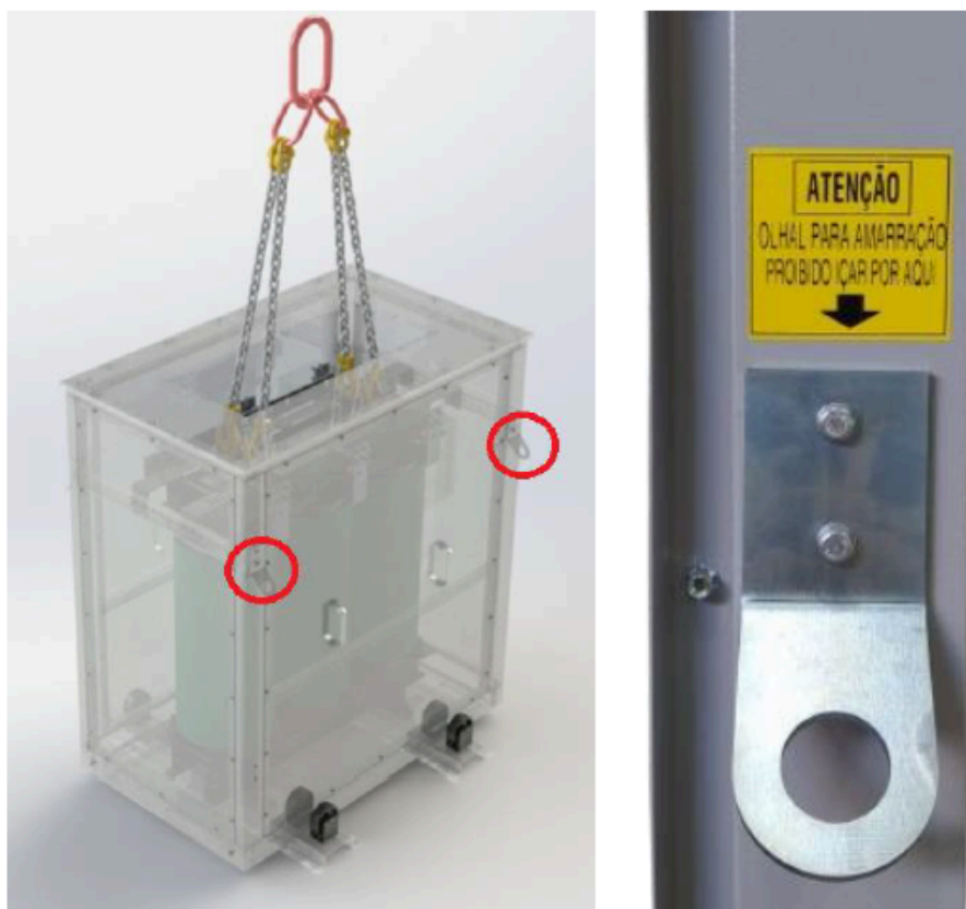
Figura 2: Detalhe dos olhais usados apenas no transporte
