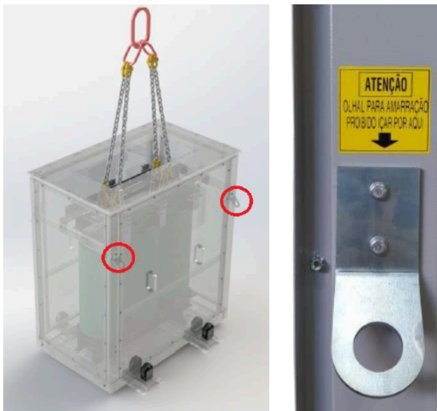
Figura 2: Detalle de los ojales utilizados únicamente en el transporte.
